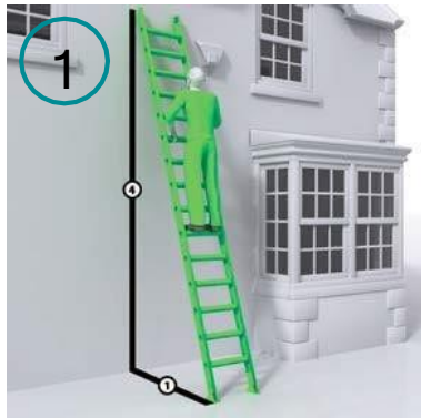
наиболее безопасный угол установки лестницы - 75 градусов
